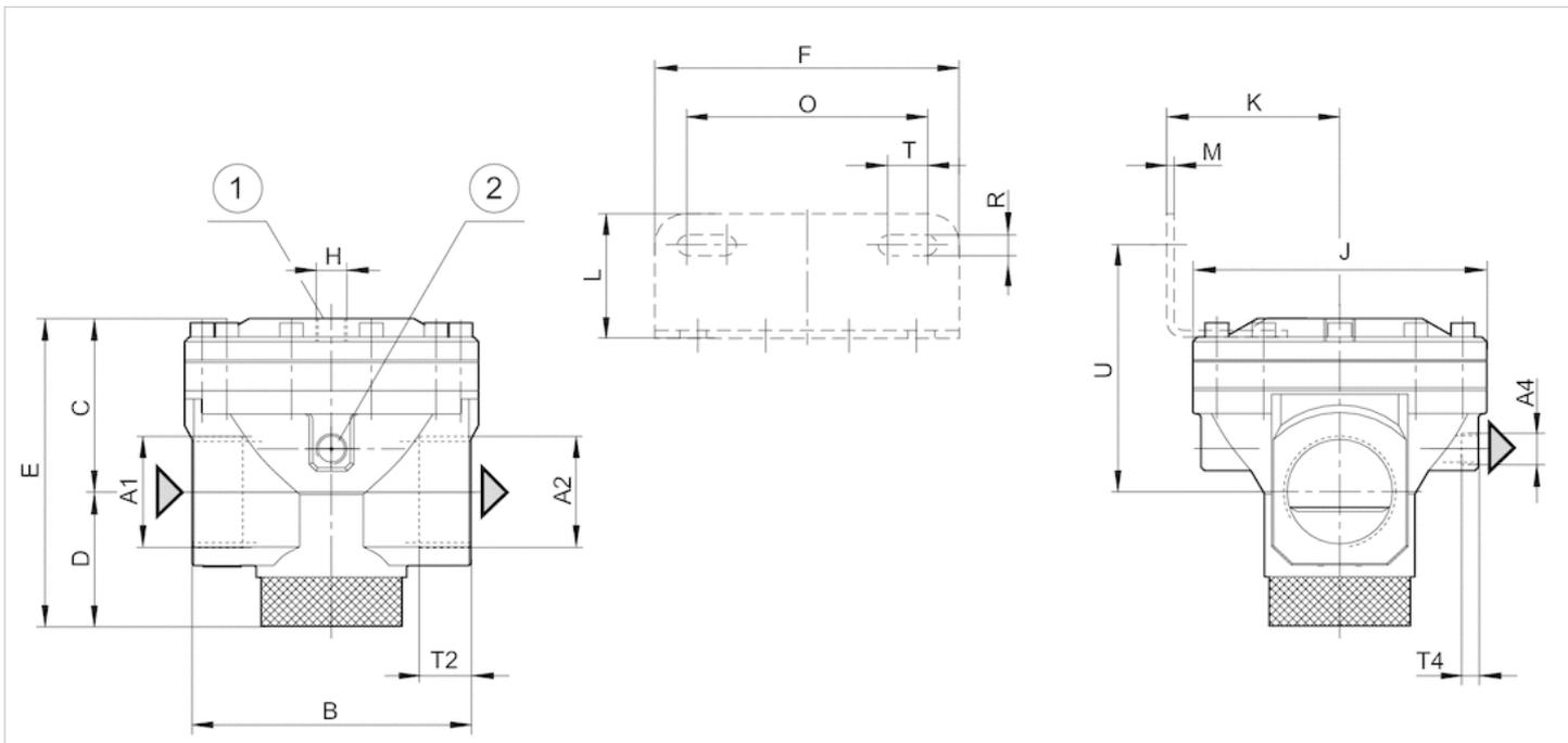
1) Steueranschluss 2) Manometeranschluss
