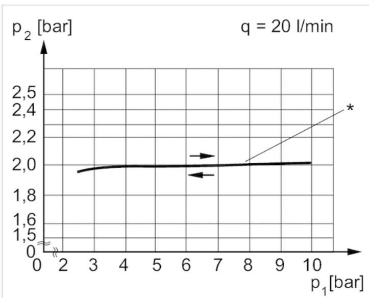
p1 = Betriebsdruck; p2 = Sekundärdruck; q = Durchfluss~\* Startpunkt
